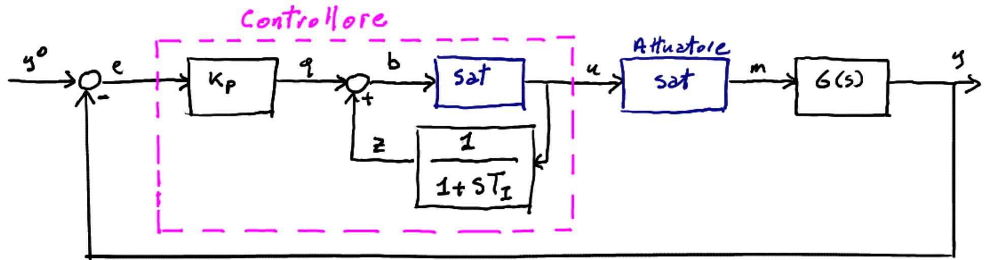
Se le saturazioni operano in zona di linearità ( $\text{sat}(x) = x$ )
