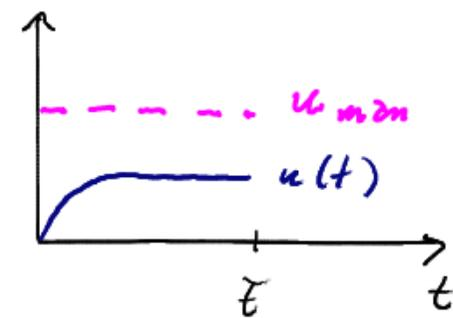
$u_{max}(\bar{t}) \neq u(\bar{t}) \rightarrow$  se a  $\bar{t}$  si commuta da M ad A, l'inserimento non è morbido
