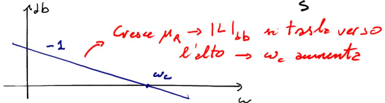
Calcolo di  $\omega_c$  in funzione di  $\mu_R$ :  $\left| \frac{0.1 \mu_R}{s \omega_c} \right| = 1 \rightarrow \omega_c = 0.1 \mu_R$
